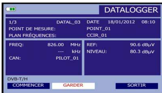
Figure 15.- Fin de l'acquisition.
