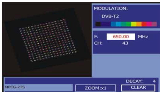
Figure 47.- Constellation Diagram. DVB-T2 (QAM 256) signal.
