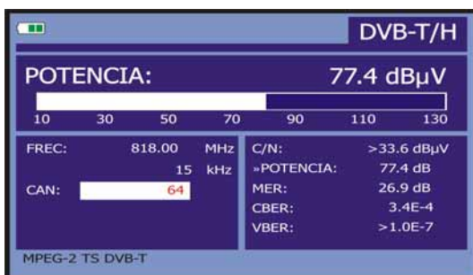
Figura 29.- Medida de la potencia de canales digitales.
