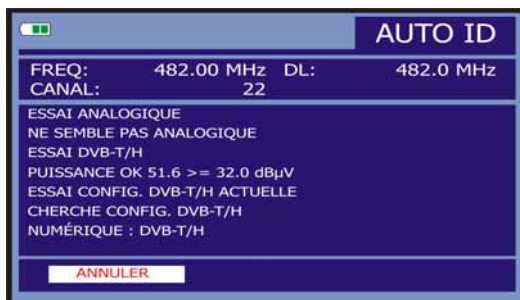
Figure 58.- Identification automatique du signal.
