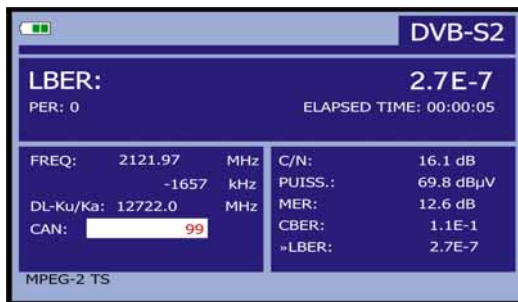
Figure 42.- Écran de mesure du LBER de signaux modulés en 8PSK. (DVB-S2).
