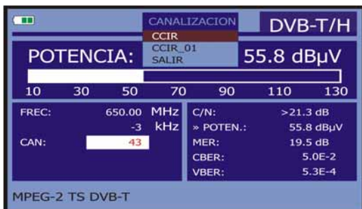
Figura 11.- Visualización del listado de tablas de canales.
