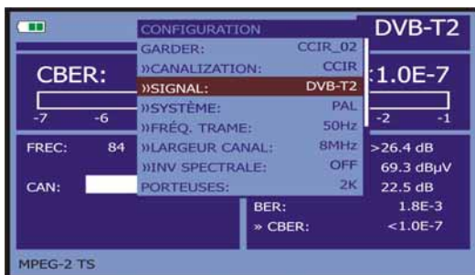
Figure 21.- Écran de configuration des mesures des signaux modulés en COFDM.
