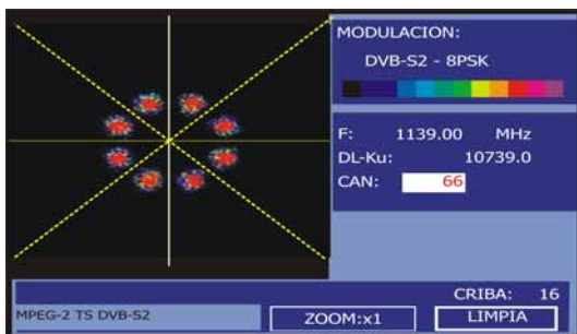
Figura 50.- Diagrama de constelación. Señal DVB-S2 (8PSK).
