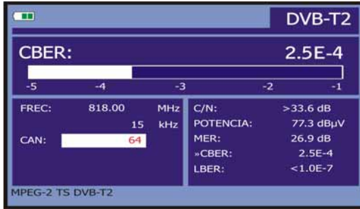
Figura 35.- Pantalla de medida del CBER de señales moduladas en COFDM.
