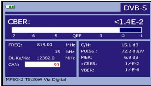
Figure 38.- Écran de mesure du CBER de signaux modulés en QPSK.
