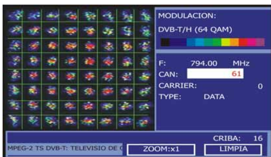
Figura 45.- Diagrama de constelación. Señal DVB-T/H (QAM 64).
