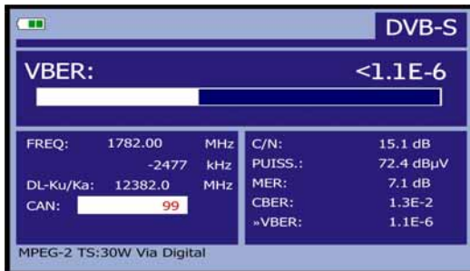
Figure 40.- Écran de mesure du VBER de signaux modulés en QPSK. (DVB-S)
