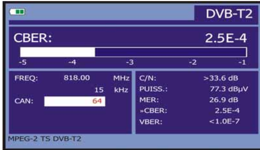
Figure 35.- Écran de mesure du CBER de signaux modulés en COFDM .
