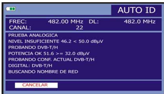
Figura 58.- Identificación automática de la señal.
