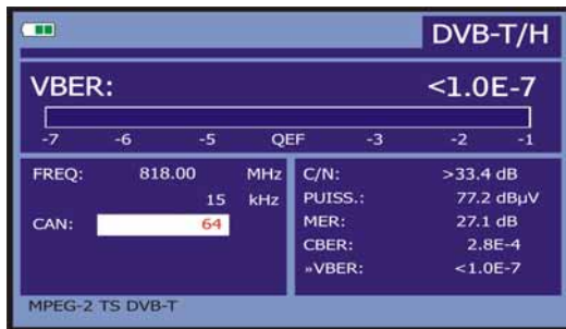
Figure 34.- Écran de mesure du BER de signaux modulés en COFDM. VBER.
