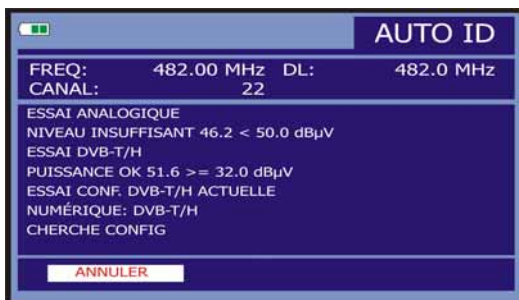
Figure 9.- Écran d'identification automatique de signaux. AUTO ID.
