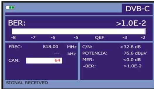
Figura 30.- Pantalla de medida del BER de señales moduladas en QAM .
