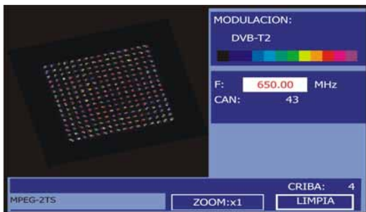
Figura 47.- Diagrama de constelación rotada. Señal DVB-T2 (QAM 256).
