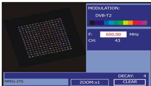
Figure 47.- Diagramme de constellation. Signal DVB-T2 (QAM 256).
