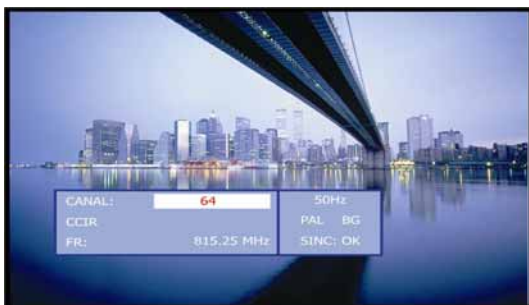
Figura 69.- Visualización de un canal analógico.
