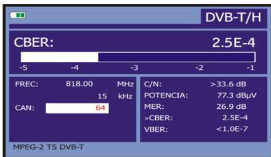
Figura 32.- Pantalla de medida del CBER de señales moduladas en COFDM.
