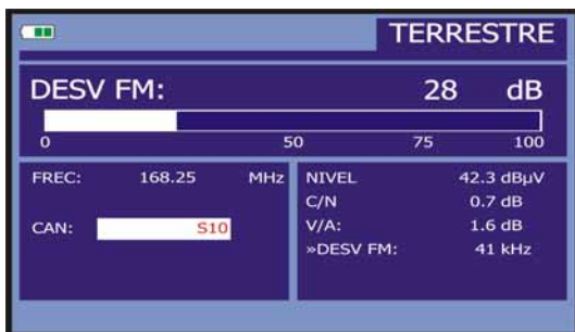
Figura 25.- Medida de la desviación instantánea de frecuencia.
