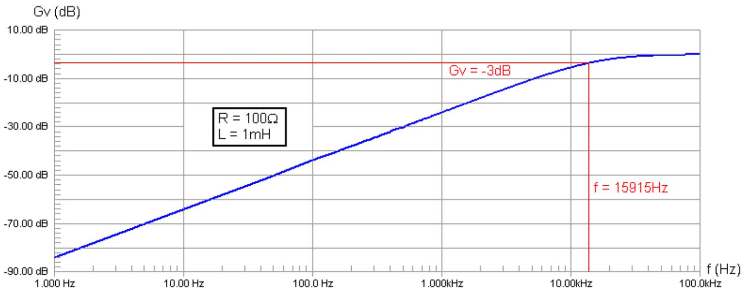
*Se puede apreciar la pendiente de -6dB/octava en la banda atenuada del filtro.*
