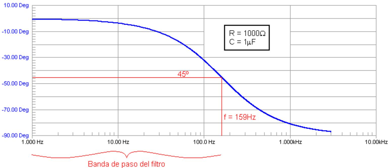
Hasta aquí todo muy bien, todo muy bonito. Pero, el filtro deberá conectar su entrada y su salida a "algo". El funcionamiento descrito más arriba sería el de un filtro conectado a una fuente de señal con impedancia nula (algo que en la práctica no pasa) y con la salida abierta (¿y entonces para qué quiero un filtro?). Lo que tendremos en la realidad sera algo como lo siguiente:
