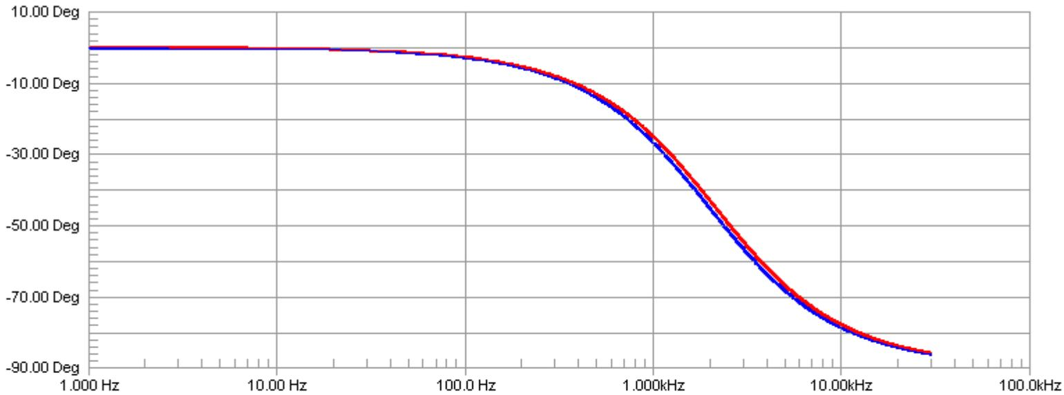
Azul: comportamiento del filtro sin conectar la resistencia de carga.
