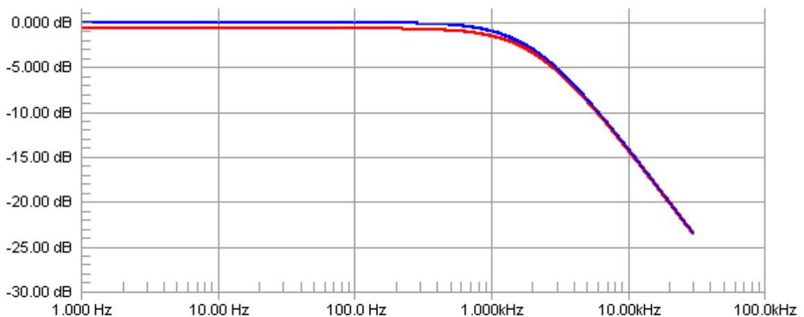
Azul: comportamiento del filtro sin conectar la resistencia de carga.
