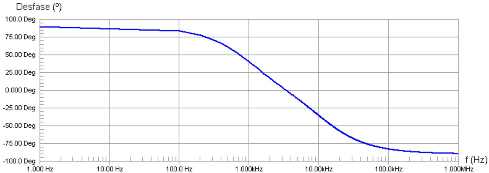
El filtro introduce un desfase de  $45^\circ$  a la **fci** y uno de  $-45^\circ$  a la **fcs**. Dentro de la banda de paso el desfase cambia gradualmente entre esos valores extremos. Fuera de la banda de paso el desfase tiende a  $90^\circ$  por la parte de las frecuencias bajas y a  $-90^\circ$  por la parte de las altas.
