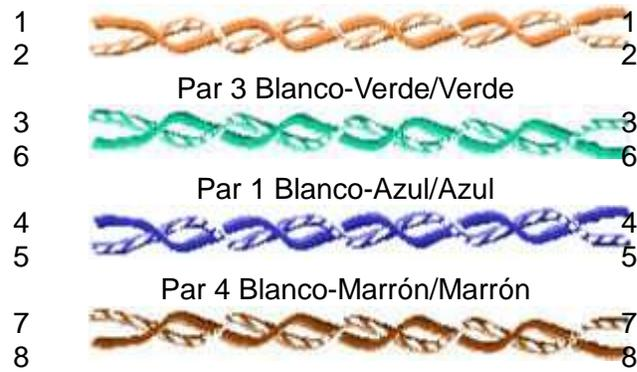
Se utilizan LATIGUILLOS CRUZADOS en los casos en los que se quiera unir dos concentradores HUB's en cascada (puerto up-link) y no se disponga en uno de los concentradores de una salida cruzada mediante un conmutador (to-Pc / to-Hub). También es utilizado si se quieren comunicar dos PC's mediante un cable de par trenzado a través de sus tarjetas de red y sin mediar entre ellos un concentrador.
