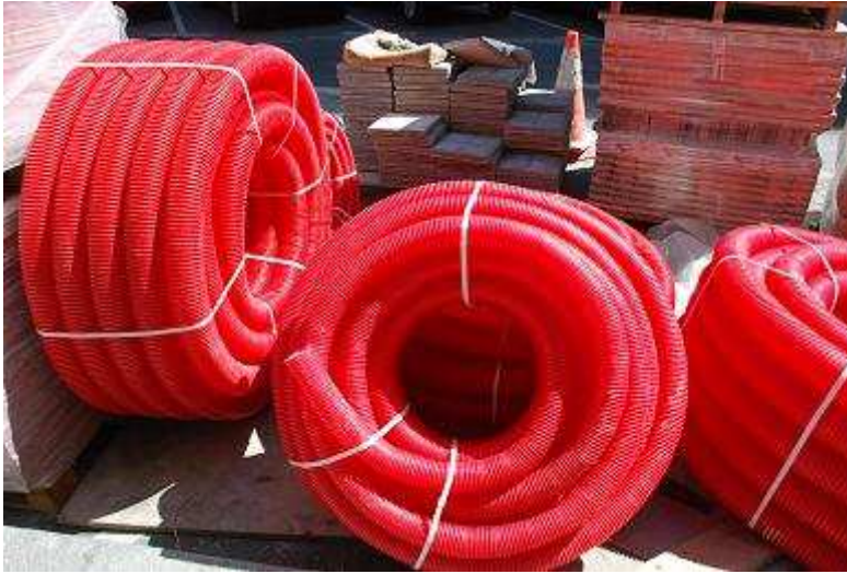
Tubos para canalizaciones
