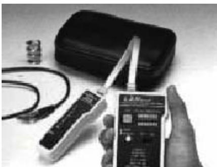
Ideal para controlar los cableados (no para certificar) por parte del técnico instalador. De bajo costo y fácil manejo.
