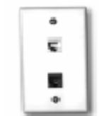
Se trata de una pieza plástica plana de soporte que es tapa de una caja estándar de electricidad embutida de 5x10 cm y permite encastrar hasta 2 keystone, formando un conjunto de conexión de hasta 2 bocas. No incluye los keystone que se compran por separado. La boca que quede libre en caso que se desee colocar un solo keystone se obtura con una tapa ciega que también se provee por separado.
